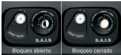
Sistema de bloqueo del freno trasero
