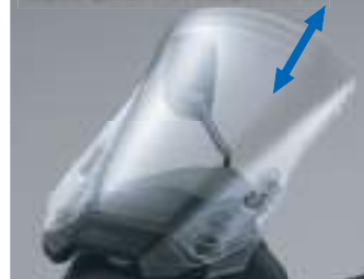
Cúpula ajustable en tres posiciones
