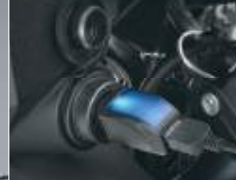
Toma de corriente DC
