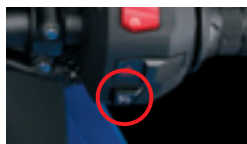
interruptor del sistema de control de crucero.
