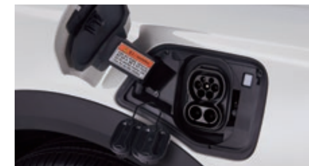
Puerto de recarga normal (CA) y puerto de recarga rápida (CC).
