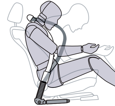
Cinturones de seguridad con doble pretensor y limitador de esfuerzo
