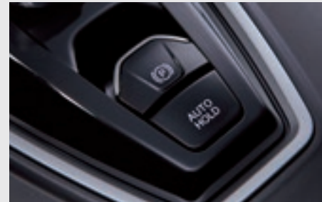
Freno de estacionamiento eléctrico (EPB) equipado con la función Auto-Hold (freno automático en parada)
