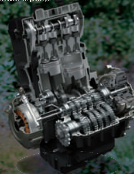
Motor bicilíndrico en paralelo 4 tiempos DOHC de 776 cc y refrigeración líquida
