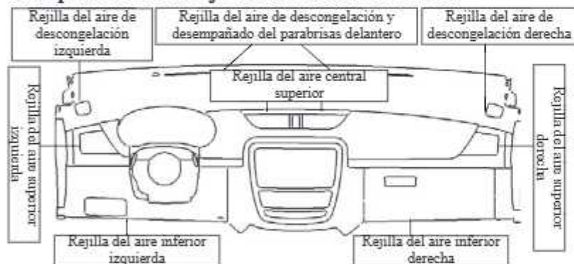
Disposición de las rejillas del aire acondicionado
