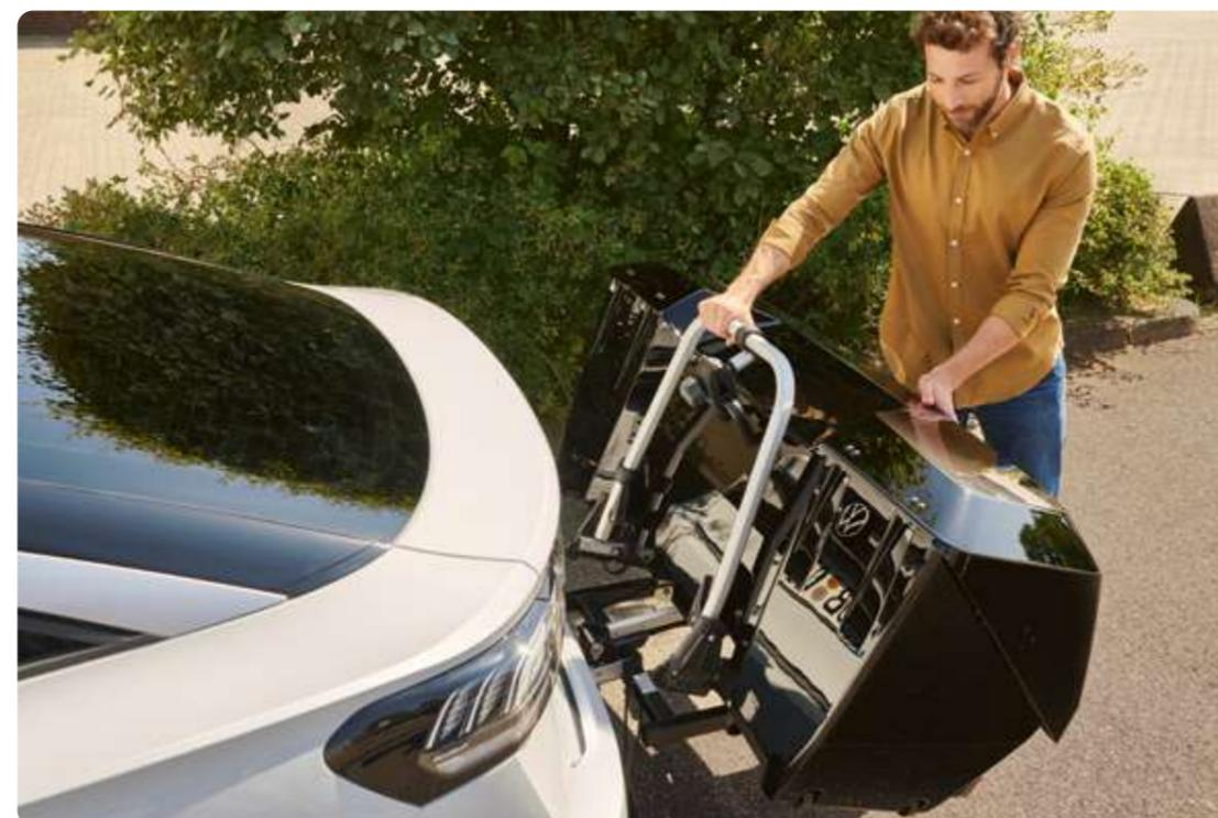
· La caja trasera se puede plegar mediante el pedal del portabicicletas para acceder libremente al maletero
