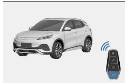
3. Después de arrancar el vehículo, mantener pulsado el botón de inicio/parada remoto de la llave inteligente durante dos segundos apaga el encendido. Entonces, los intermitentes parpadean dos veces.
