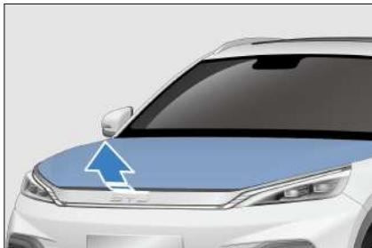
3. Despues de cerrar el capó, inspeccione si el pestillo está bien bloqueado. Si el capó se puede levantar ligeramente, indica que no está correctamente bloqueado. Abra nuevamente el capó y luego ciérrelo correctamente según los pasos anteriores.
