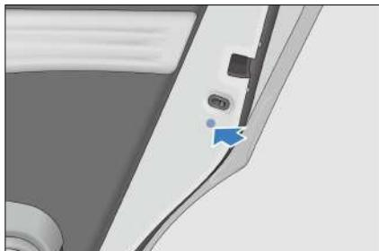
La etiqueta de la punta de uso del conector de carga está adherida a la superficie interior de la puerta del puerto de carga.
