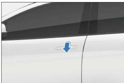
3. Tire del tirador de la puerta del conductor hasta alcanzar su ángulo máximo. Inserte, gire y, a continuación, saque la llave mecánica. Tire del tirador para abrir la puerta.
